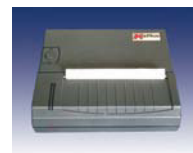
Термопринтер № 16595 для чтения параметров работы через порт RS 232
