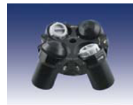
Ротор с переменным углом 4×250 мл № 12177 для бакетов № 13174, № 13178 и № 13180 Скорость 5000 об/мин Ускорение 4724 g R = 16,9 см
