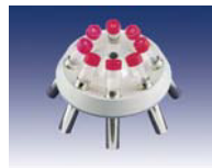
Угловой ротор 8×15/10 мл № 11741C с бакетами № 13080 или № 13081 Скорость 6000 об/мин Ускорение 4226 g R = 10,5 см Угол 30°
