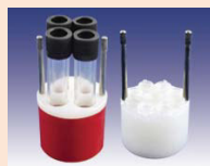
№ 14449 4×12 мл и для систем забора крови (Ø 17/19,4×60/107 мм) № 14450 9×2,2/1,5 мл (Ø 11×36,5 мм) Eppendorf
