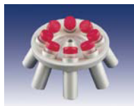
Угловой ротор 8×50 мл № 11213 для бакетов № 13275 или № 13276 Скорость 5500 об/мин Ускорение 4227 g R = 12,5 см Угол 30°
