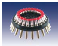
Угловой ротор 24×15 мл № 11210C с бакетами № 13080 или № 13081 Скорость 5000 об/мин Ускорение 3996 g R = 14,3 см Угол 30°
