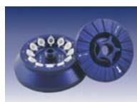
Угловой ротор 12×2/1,5 мл № 11202a с герметичной крышкой. Скорость 14000 об/мин. Ускорение 14243 g. Rmax = 6,5 см. Rmin = 3,4 см. Угол 45°. Пробирки 2,2 мл № 15123
