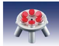
Угловой ротор 6×50 мл № 11746C с бакетом 13276 Скорость 6000 об/мин Ускорение 4427 g R = 11 см Угол 30°
