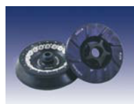
Угловой ротор 18×0,5 мл № 11203 с герметичной крышкой Скорость 14000 об/мин Ускорение 12928 g Rmax = 5,9 см Rmin = 3,8 см Угол 45° Пробирки 0,5 мл № 15127
