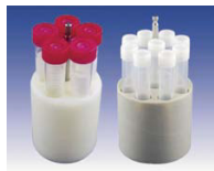
№ 14153 5×15 мл Falcon (Ø 17/22×120 мм) № 14154 9×5 мл (Ø 13,5/17×81 мм) и для систем забора крови
