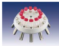
Угловой ротор 12×15/10 мл № 11740 Скорость 5500 об/мин Ускорение 4058 g R = 12 см Угол 30° Угловой ротор 8×15/10 мл № 11741 Скорость 6000 об/мин Ускорение 4226 g R = 10,5 см Угол 30°
