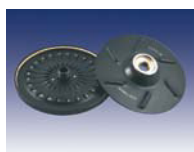
Гематокритный ротор на 24 капилляра 50 мм № 12205 Скорость 14000 об/мин Ускорение 13586 g Rmax = 6,2 см Rmin = 1,2 см Стекланные капилляры 19 мкл (Ø 1,3×50 мм) № 15101
